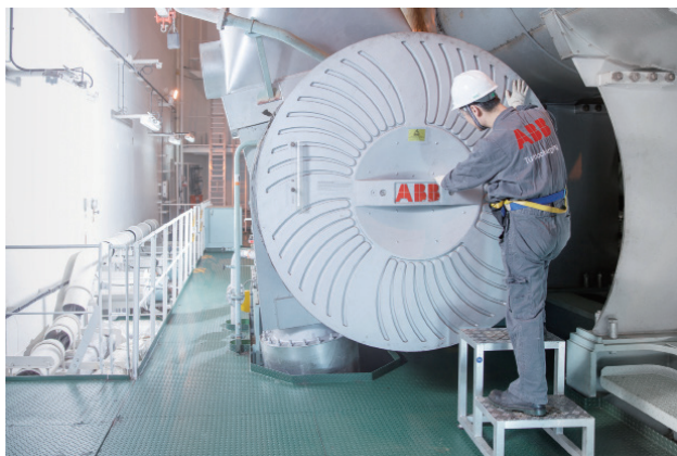
ABB工程师在机舱检修涡轮增压器
